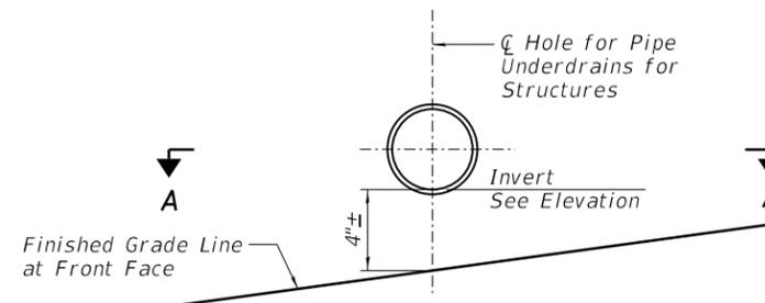
**UPPER UNDERDRAIN OUTLET DETAIL**
