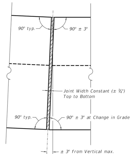
PRECAST UNIT JOINT ELEVATION
