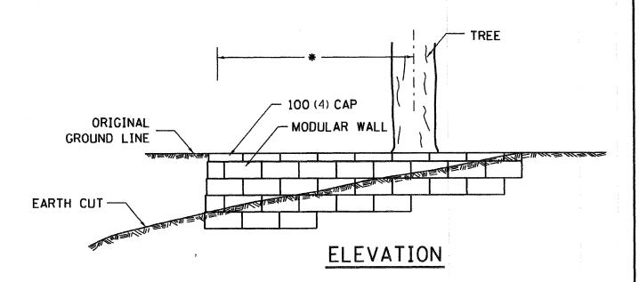
HEIGHT OF WALL DEPENDENT ON SLOPE OF THE CUT.
