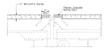
TYPICAL SECTION AT EXPANSION JOINTS
