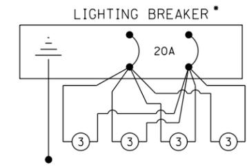
\* INCIDENTAL TO CONTROLLER PRICE. CONTROLLER POWER SHALL BE ON LINE SIDE OF LIGHTING POWER.
