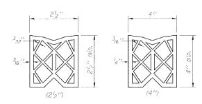
PREFORMED JOINT SEAL
