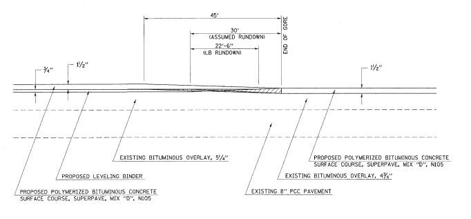
BITUMINOUS SURFACE REMOVAL - BUTT JOINT
