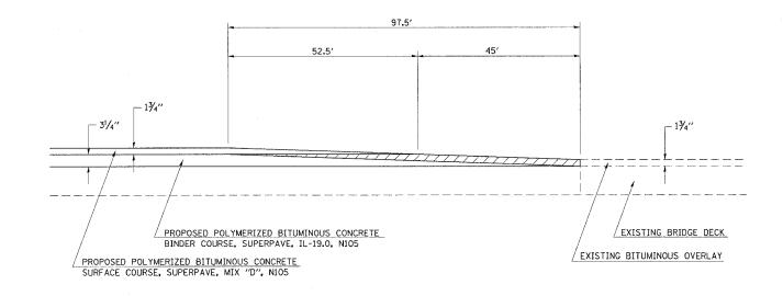
BITUMINOUS SURFACE REMOVAL - BUTT JOINT
