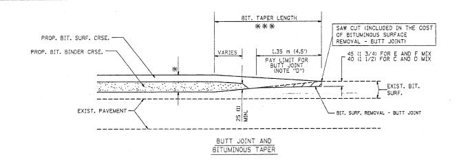
TYPICAL BUTT JOINT AND BITUMINOUS TAPER
