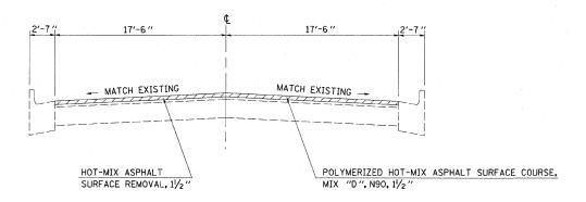
HOT-MIX ASPHALT SURFACE REMOVAL, 11/2"
