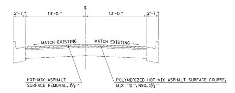
HOT-MIX ASPHALT SURFACE REMOVAL, 11/2"
