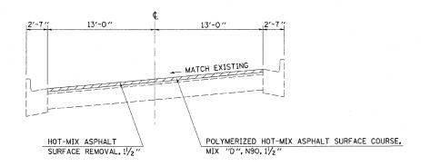
HOT-MIX ASPHALT SURFACE REMOVAL, 11/2"
