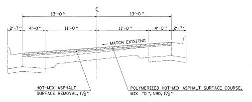
HOT-MIX ASPHALT SURFACE REMOVAL, 11/2"
