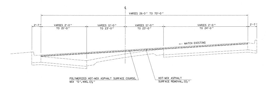
HOT-MIX ASPHALT SURFACE REMOVAL, 11/2"
