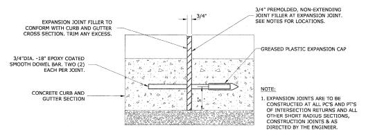
**TYPICAL CURB AND GUTTER EXPANSION JOINT**
