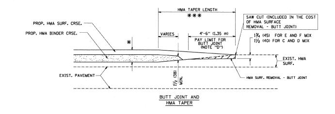
TYPICAL BUTT JOINT AND HMA TAPER
