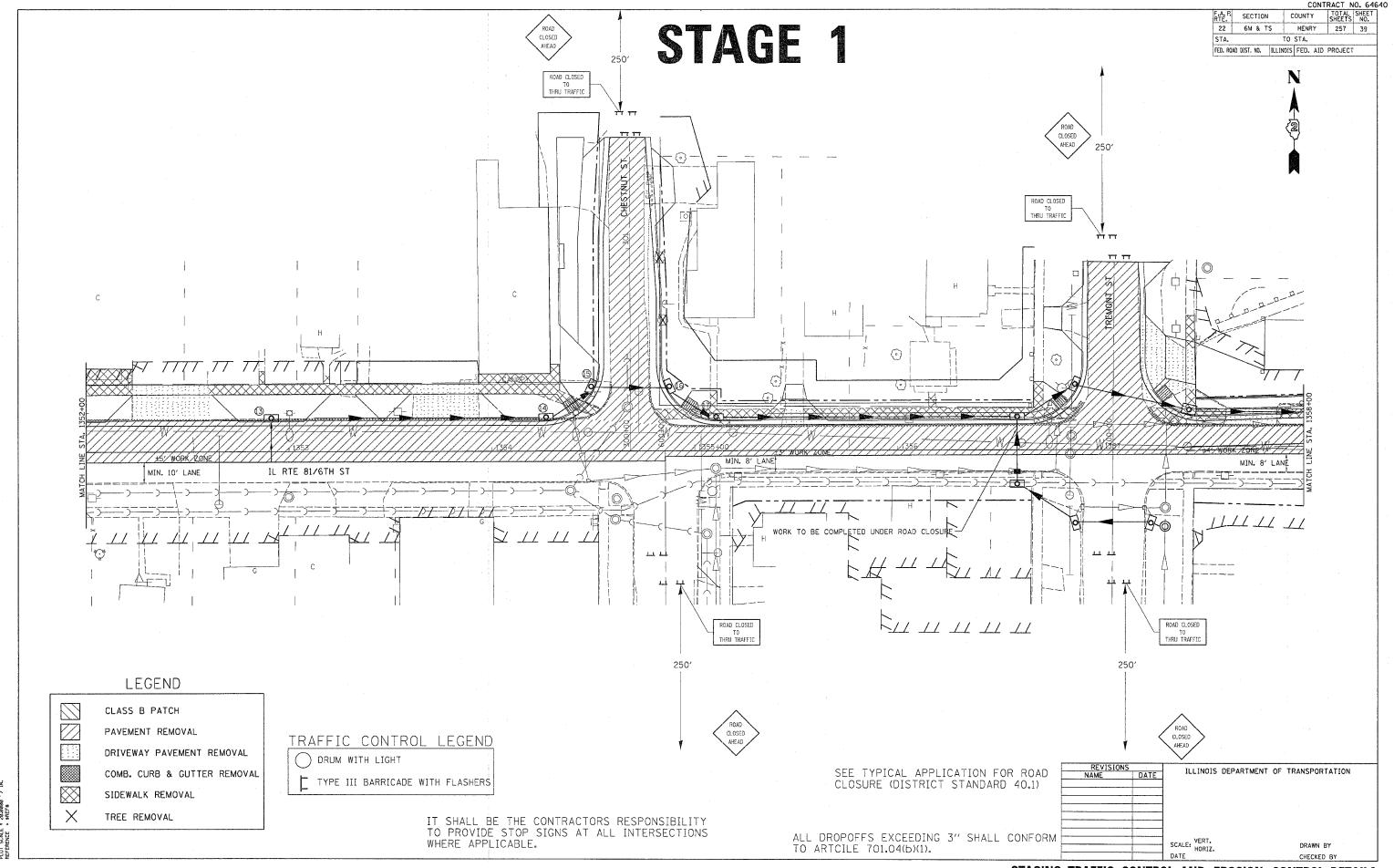
STAGING, TRAFFIC CONTROL, AND EROSION CONTROL DETAILS
