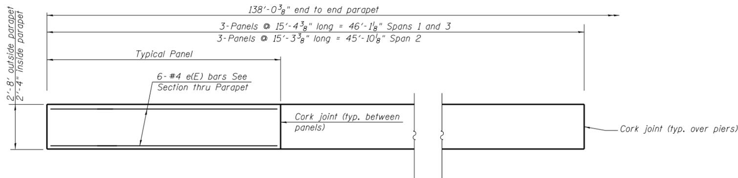
**INSIDE ELEVATION OF PARAPET**
