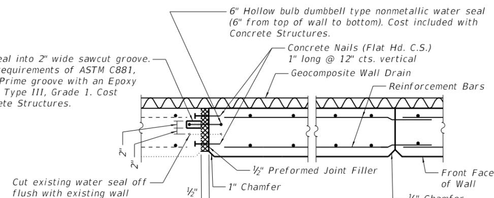
**EXPANSION JOINT CONSTRUCTION JOINT**
