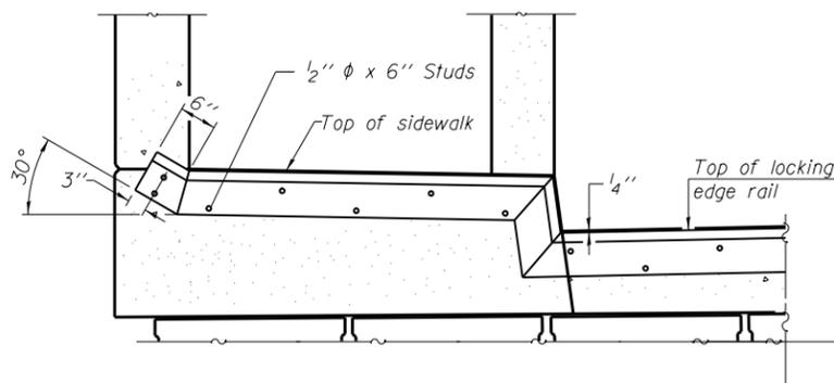
**END TREATMENT OF STRIP SEAL AT SIDEWALK**
