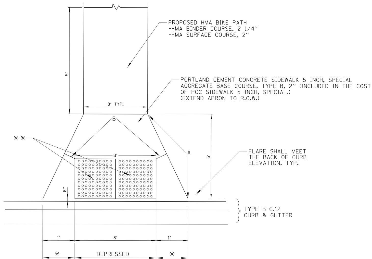
\* 1' TRANSITION FROM DEPRESSED CURB AND GUTTER TO FULL HEIGHT CURB AND GUTTER
