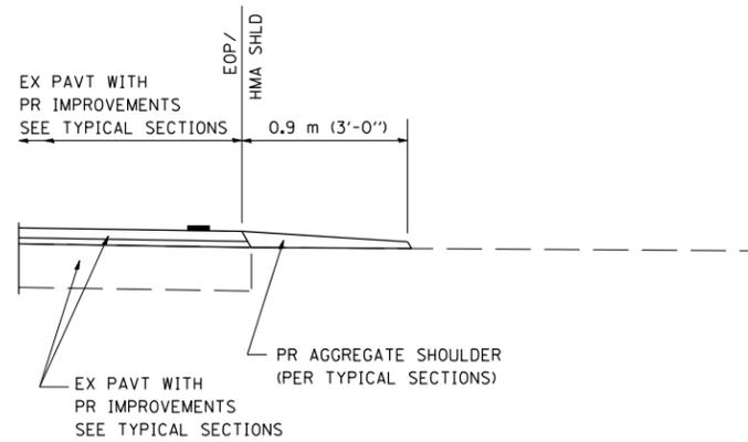
**SECTION A-A FOR EX EARTH/AGGREGATE FE**
