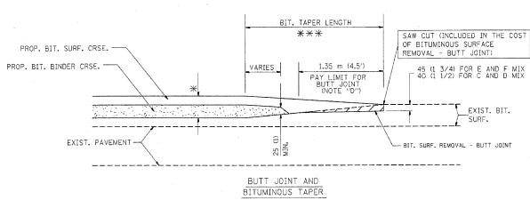
TYPICAL BUTT JOINT AND BITUMINOUS TAPER
