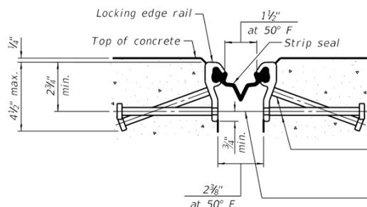
SHOWING ROLLED RAIL JOINT
