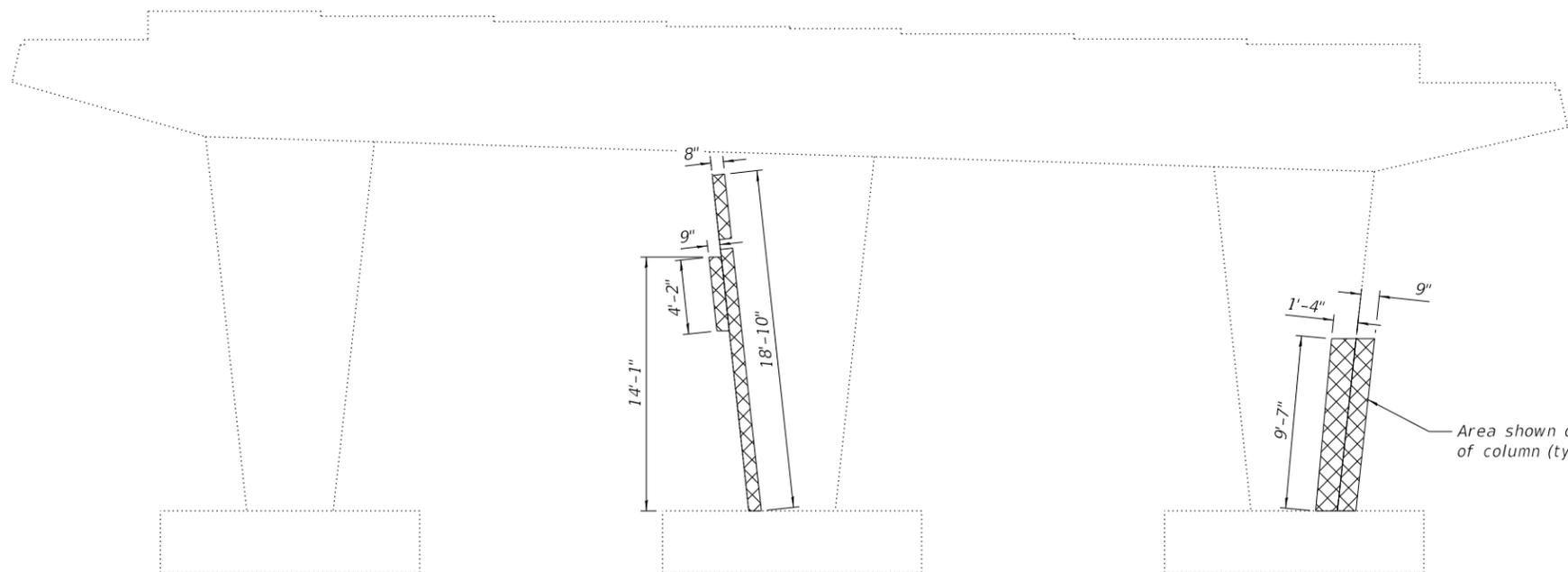
**PIER 2 ELEVATION - REPAIR**
