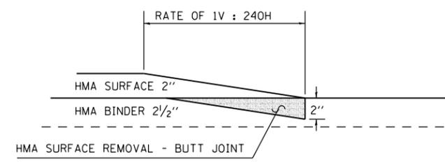
**HMA SURFACE REMOVAL - BUTT JOINT - IL ROUTE 3**
