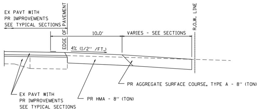
SECTION A-A FOR EX EARTH/AGGREGATE CE
