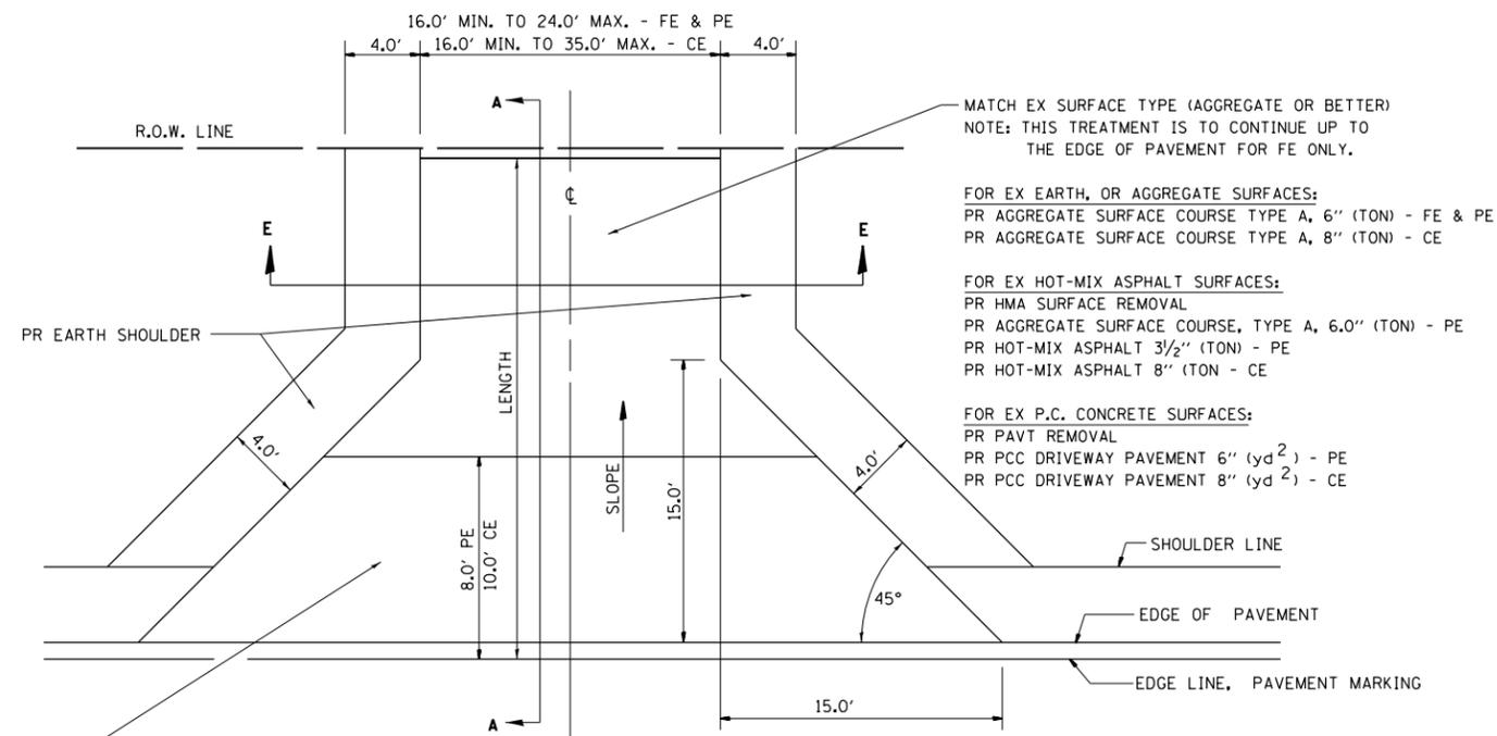
FOR EX EARTH, AGGREGATE, OR HOT-MIX ASPHALT SURFACES:
