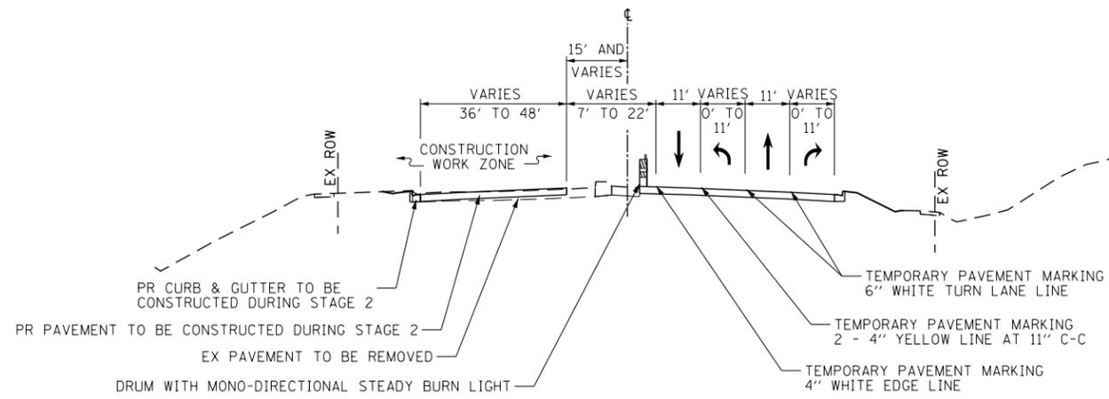
MAINTENANCE OF TRAFFIC TYPICAL SECTION - STAGE 2
