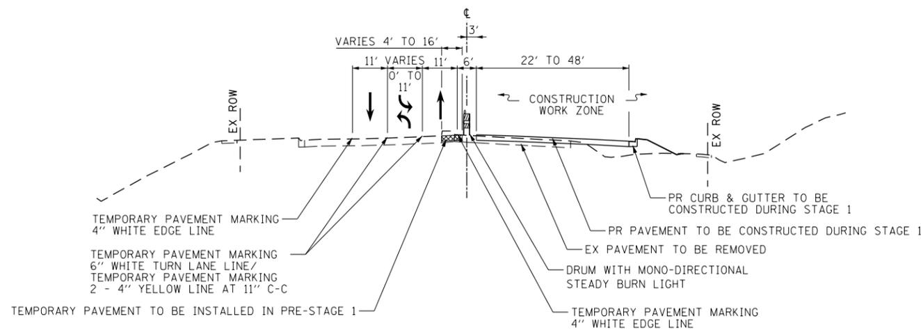
MAINTENANCE OF TRAFFIC TYPICAL SECTION - STAGE 1
