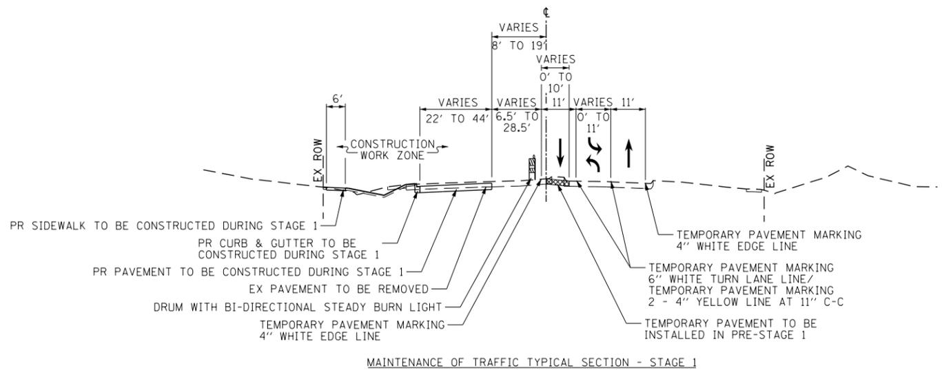
MAINTENANCE OF TRAFFIC TYPICAL SECTION - STAGE 1
