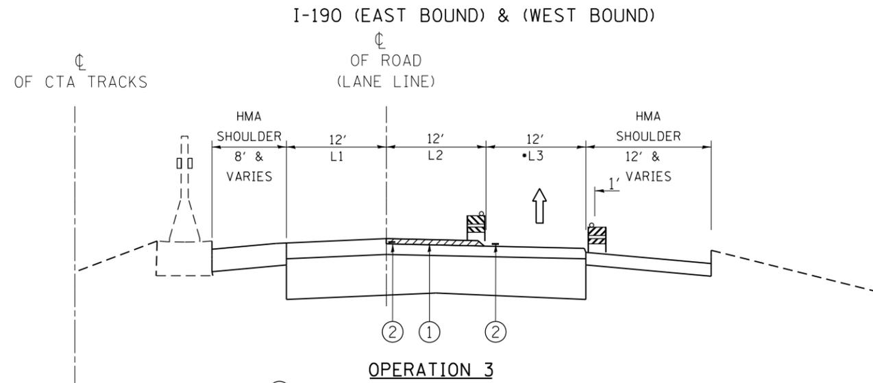
① HOT MIX ASPHALT SURFACE REMOVAL, 2"
