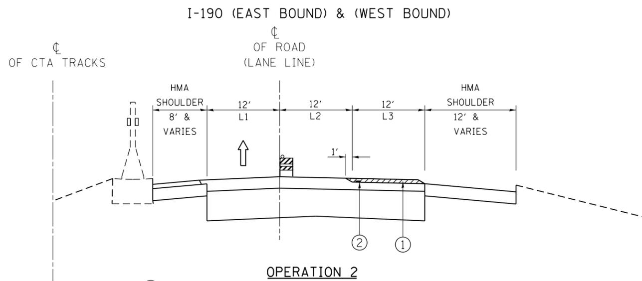
① HOT MIX ASPHALT SURFACE REMOVAL, 2"
