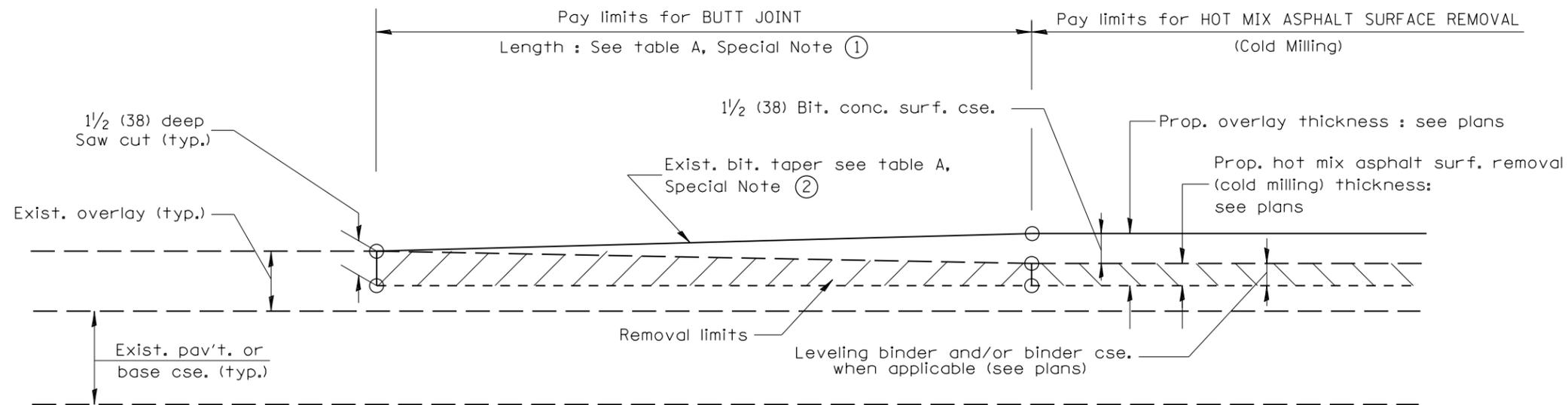
**CASE 3 : WITH HOT MIX ASPHALT SURFACE REMOVAL (COLD MILLING)
