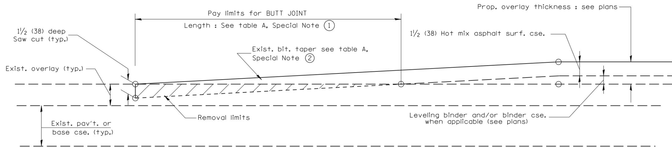
**CASE 4 : NO HOT MIX ASPHALT SURFACE REMOVAL (COLD MILLING)
