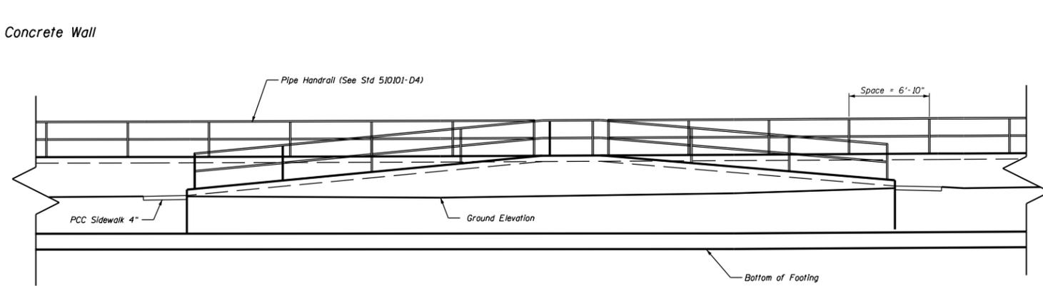
**ELEVATION - A.D.A. RAMP**
