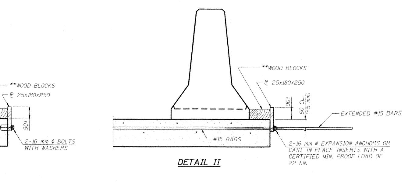
\*\* WOOD BLOCKS MAY BE OMITTED WHEN REQUIRED TO PROVIDE MINIMUM STAGE TRAFFIC LANE WIDTH. WHEN THE WOOD BLOCKS ARE OMITTED, THE CONCRETE BARRIER SHALL BE IN DIRECT CONTACT WITH THE STEEL RETAINER PLATE.
