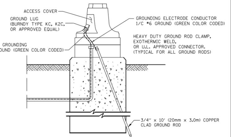
**MAST ARM POLE / POST-GROUNDING DETAIL**
