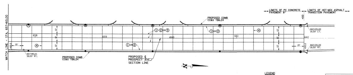
PROPOSED 1" EXPANSION JOINTS PROPOSED LONGITUDINAL JOINTS
