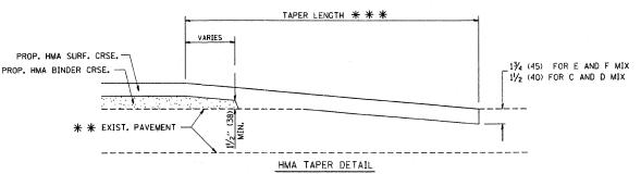
TYPICAL BUTT JOINT AND HMA TAPER
