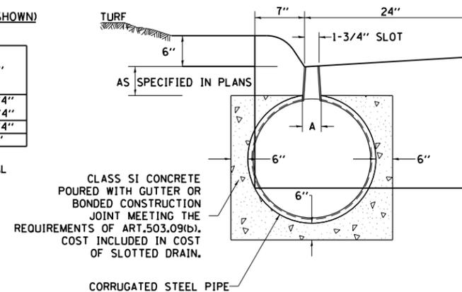
DETAIL FOR CURB & GUTTER
