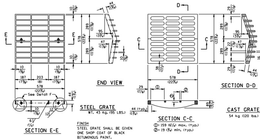
FINISH STEEL GRATE SHALL BE GIVEN ONE SHOP COAT OF BLACK BITUMINOUS PAINT.
