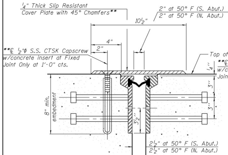
SECTION THRU ROLLED RAIL JOINT AT SIDEWALK
