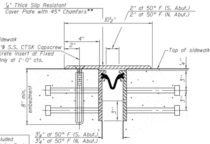
SECTION THRU ROLLED RAIL JOINT AT SIDEWALK
