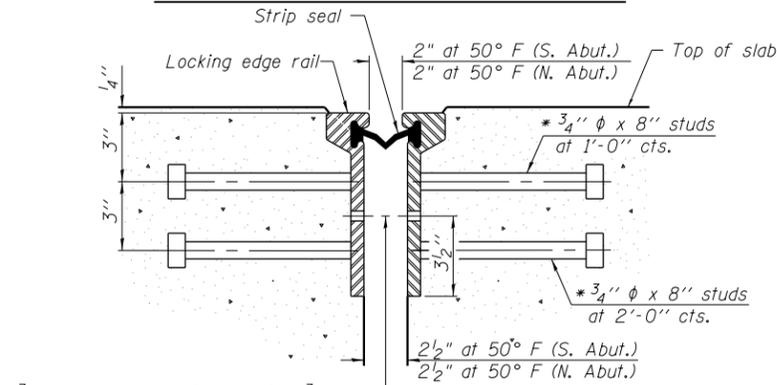
SECTION THRU ROLLED RAIL JOINT AT ROADWAY
