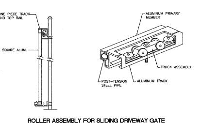
NOTE: GATE AND ROLLERS SHALL BE MOUNTED INBOARD
