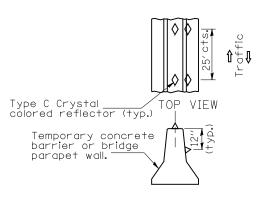
BARRIER WALL REFLECTORS DETAIL
