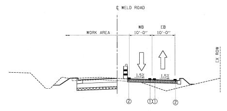
WELD ROAD STAGE II.1 TYPICAL SECTION FROM STA. 6+00 TO STA. 24+00
