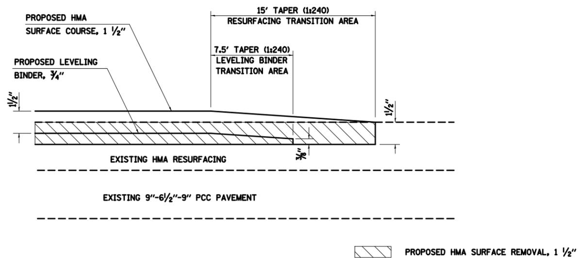
**BUTT JOINT ELEVATION VIEW**
