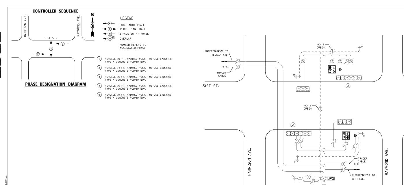
TRAFFIC SIGNAL INSTALLATION ELECTRICAL SERVICE REQUIREMENTS WATTAGE\_\_\_\_ % OPERATIONS TOTAL NO. LAMPS WATTAGE INCAND. LED SIGNAL (RED) 1 35 17 0.50 51 (YELLOW) 1 35 25 0.25 38 6 (GREEN) 1 35 15 0.25 23 6 ARROW 1 35 12 0.10 0 PED. SIGNAL 90 25 50 1.00 CONTROLLER 100 100 1.00 100 ILLUM. SIGN 252 25 0.05 VIDEO SYSTEM 1.00 150
