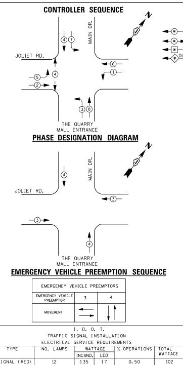
SIGNAL (RED) (YELLOW) 1 35 25 0.25 75 12 (GREEN) 12 1 35 15 0.25 45 ARROW 1 35 12 0.10 20 PED. SIGNAL 50 90 25 1.00 CONTROLLER 100 100 1.00 100 ILLUM. SIGN 252 25 0.05 VIDEO SYSTEM 1.00 150 FLASHER LED TOTAL = 392
