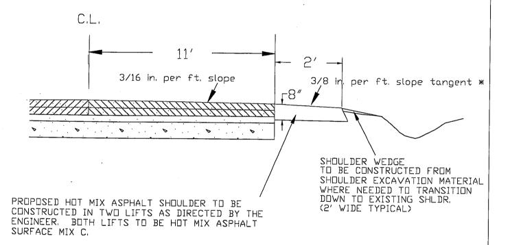
\* H. CURVE SHOULDER SLOPE SHALL BE ADJUSTED SO THAT THE ALGEBRAIC DIFFERENCE BETWEEN THE PAVEMENT AND SHOULDER SLOPES DOES NOT EXCEED 0.08 FT/FT.
