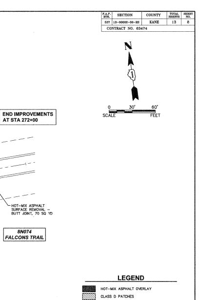
HOT-MIX ASPHALT SURFACE REMOVAL - BUTT JOINT HOT-MIX ASPHALT DRIVEWAY PAVEMENT, 5"
