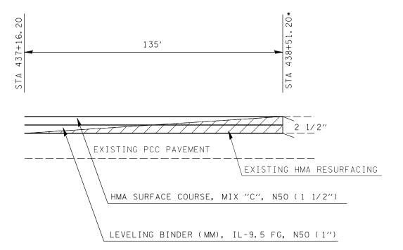
HMA SURFACE REMOVAL - BUTT JOINT (VARIES FROM 0" TO 2 1/2")
