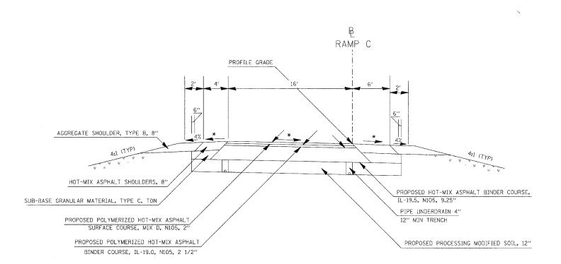
ATTAIN SUPERELEVATION STA 502+25.12 TO STA 504+45.12
