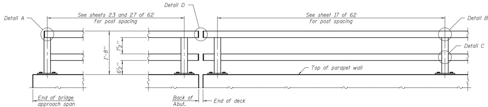
**PARAPET RAILING ELEVATION**
