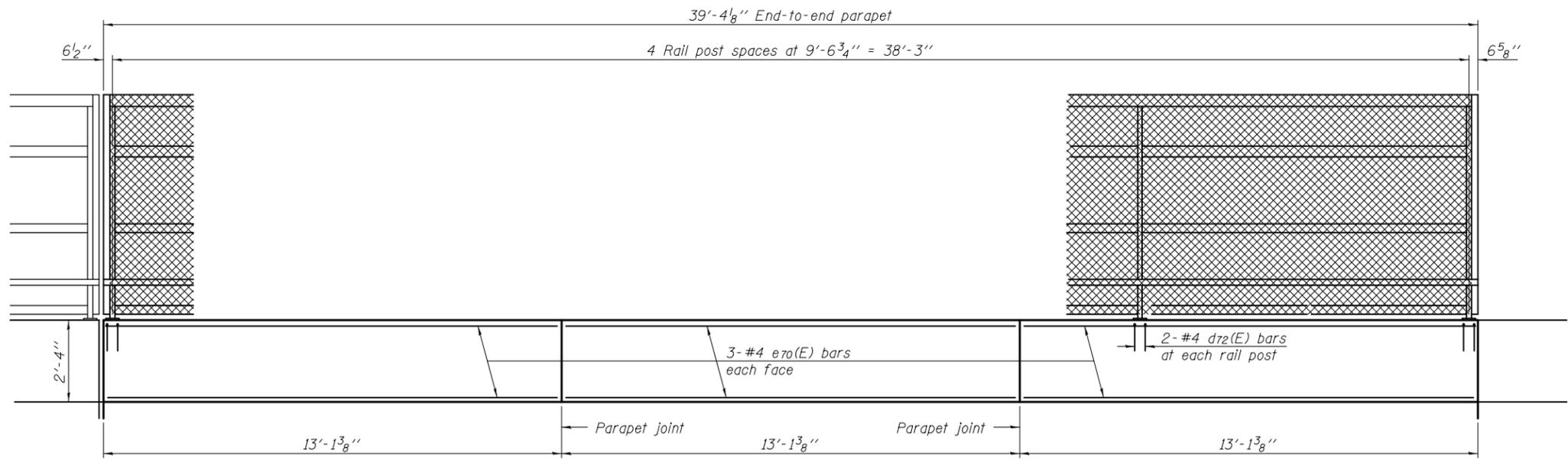
**INSIDE ELEVATION OF WEST SIDEWALK PARAPET WALL**
