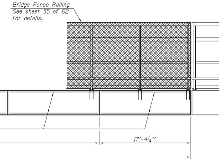
**INSIDE ELEVATION OF WEST SIDEWALK PARAPET WALL**
