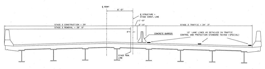
STAGE 2 CONSTRUCTION (LOOKING IN DIRECTION OF TRAFFIC)
