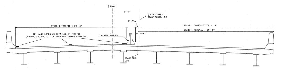
STAGE 1 CONSTRUCTION (LOOKING IN DIRECTION OF TRAFFIC)
