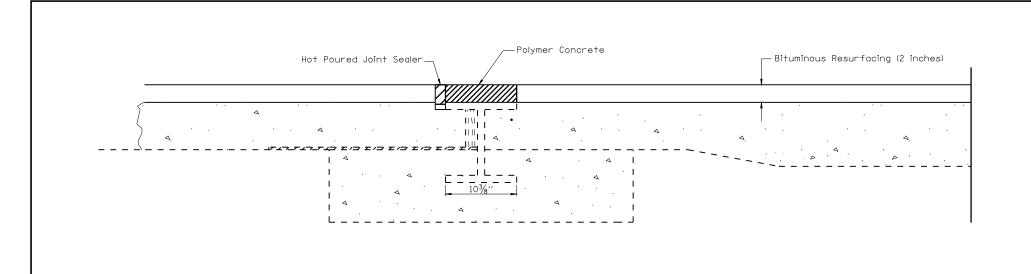
WIDE FLANGE BEAM TERMINAL JOINT SECTION SB STA. 110+90.00
