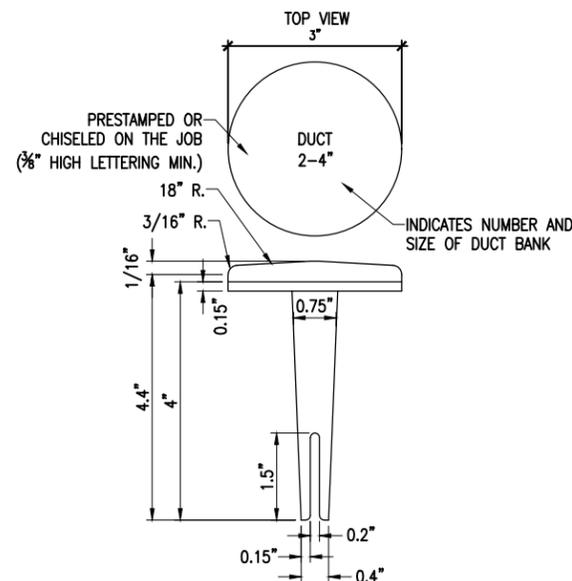
**BITUMINOUS PAVEMENT DUCT MARKERS**
