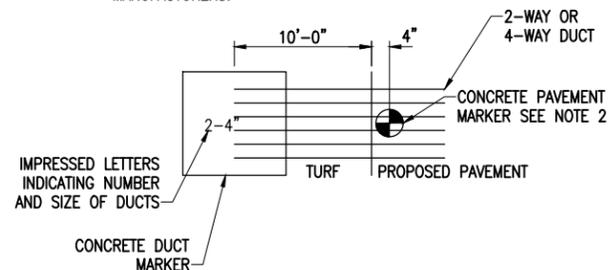
**DUCT MARKER DETAIL-PLAN**
