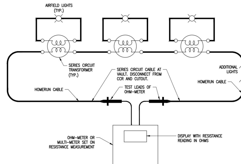
**MEASURE RESISTANCE OF SERIES CIRCUIT LOOP.**
