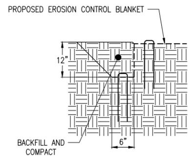
**EROSION CONTROL BLANKET TOE-IN ANCHOR DETAIL**
