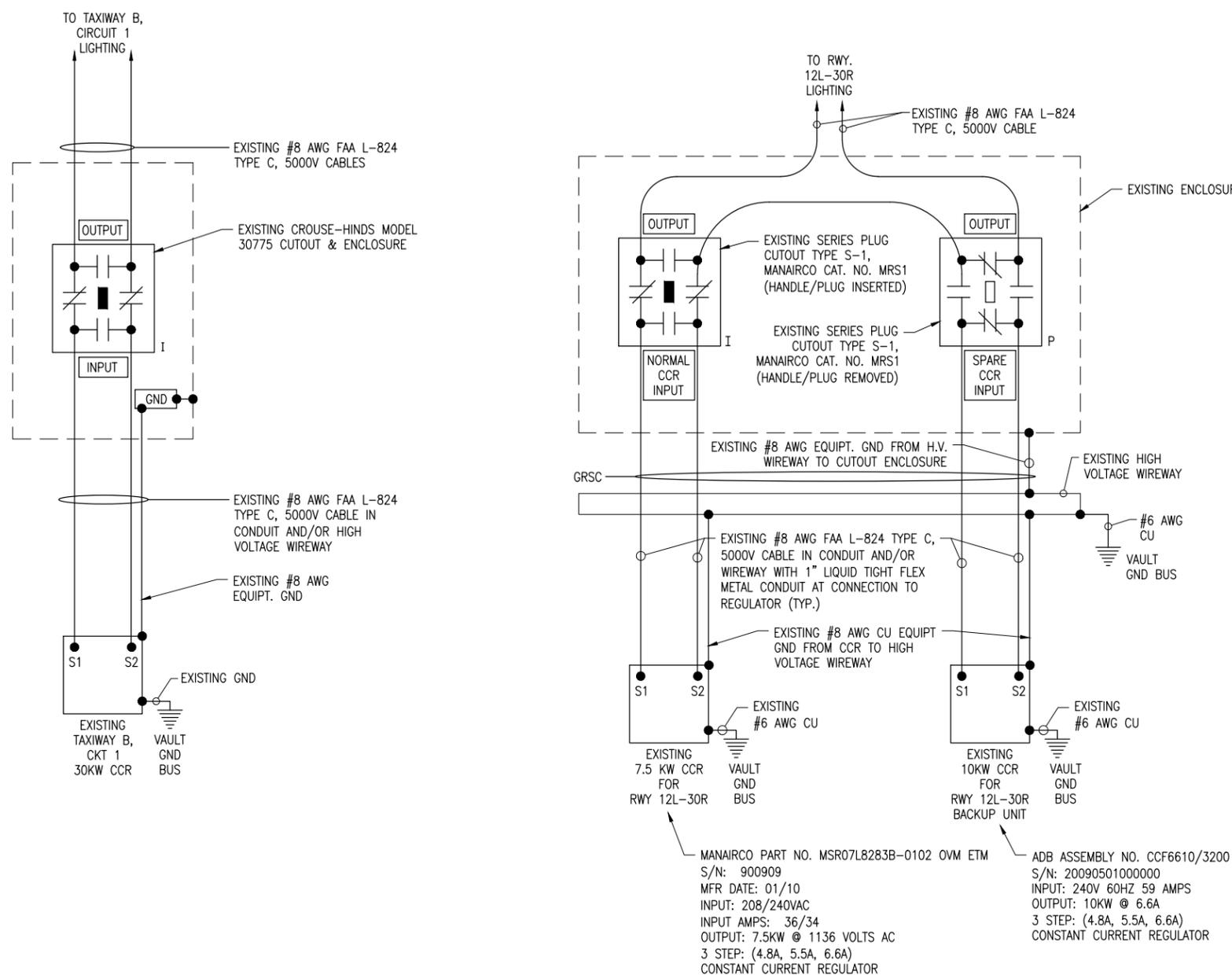
EXISTING HIGH VOLTAGE WIRING SCHEMATIC FOR RUNWAY 12L-30R & TAXIWAY B CIRCUIT NO. 1
